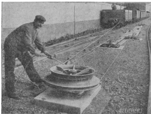
Abb. 9. Endumföhrungsscheibe einer Seilrangieranlage mit Spillkopf.
